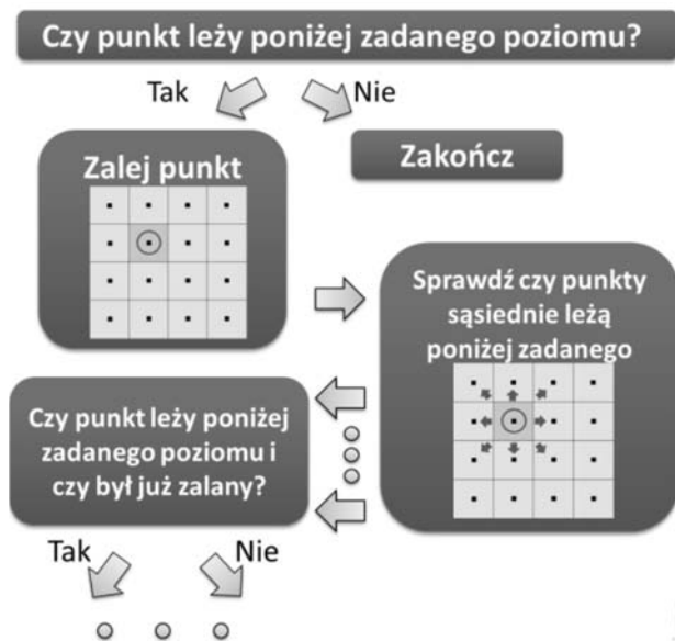
Rys. 10. Algorytm obliczania obszaru zalanego Źródło: opracowanie własne.
