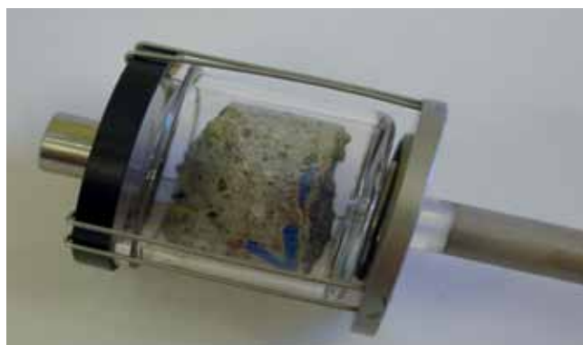
Rys. 8. Przykładowa próbka betonu przygotowana do badań porowatości metodą porozymetrii rtęciowej
