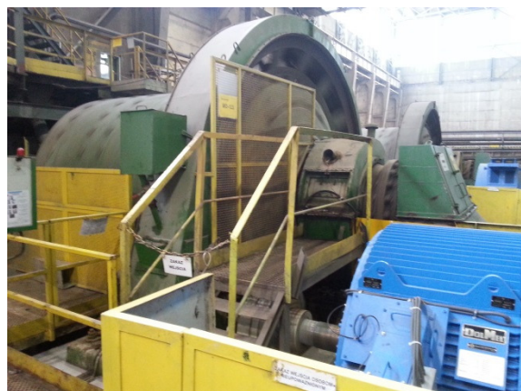
Rys. 1. Prototypowy silnik LSPMSM (SMH-1732T, 630kW) na stacji prób oraz zainstalowany na obiekcie
