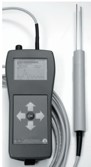
Rys. 4. Ręczny miernik wilgotności gleby Fig. 4. Handheld soil moisture meter
