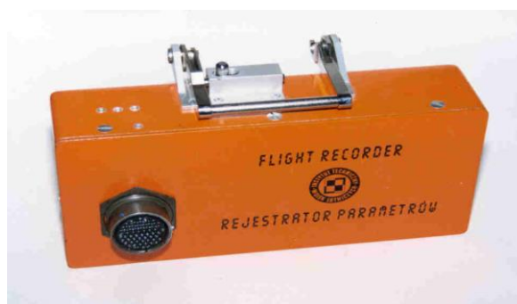
Rys. 8. Rejestrator IP-16 współpracujący z rejestratorem BUR-1M na samolotach M-28 „Bryza”.
