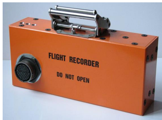
Rys. 7. Rejestrator IP-8 zastępujący rejestrator MŁP-14 samolotu Su-22.
