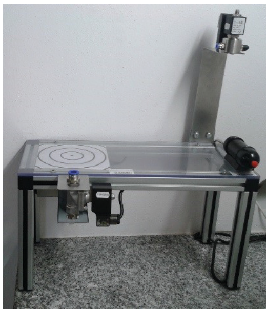
Rys. 11. Skompletowane i zmontowane stanowisko do konfekcjonowania CRM
