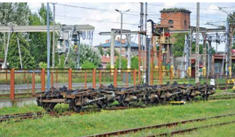
Wózki 1435 mm przy konwencjonalnym stanowisku przestawczym na stacji Przemysł (28.07.2015 r.)
