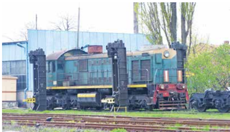
SM48-032 podczas konwencjonalnej zmiany rozstawu kół na stacji Chełm (01.05.2006 r.)
