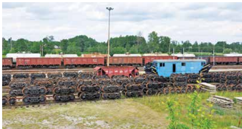
Wózki wagonowe na stacji Sędziszów na linii LHS (11.06.2016 r.)
