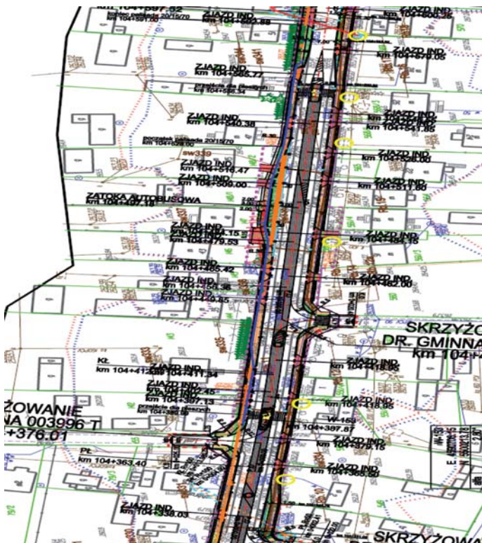
Rys. 7. Plan przejścia przez Promnik (źródło: projekt firmy MGGP – Rozbudowa DW 786, własność ŚZDW)
