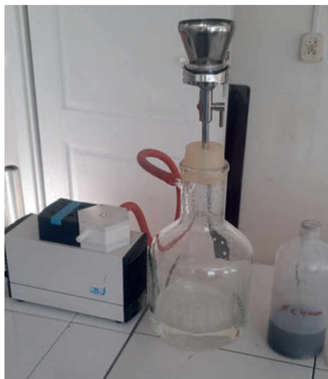
Fot. 5. Filtracja próżniowa próbek Fig. 5. Vacuum filtration of samples
