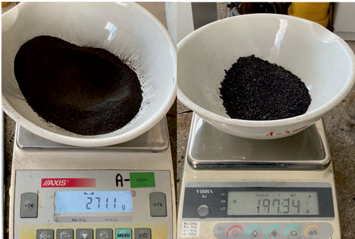
Fot. 2. Dwie frakcje próbek z hałdy wałbrzyskiej a) \varnothing < 1 \text{ mm} , b) \varnothing < 4 \text{ mm} Fig. 2. Two fractions of samples from The Wałbrzych heap a) \varnothing < 1 \text{ mm} , b) \varnothing < 4 \text{ mm}
