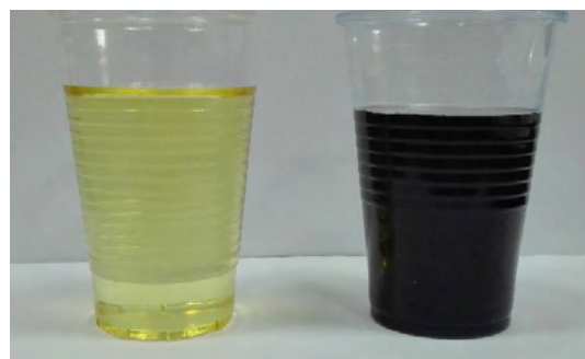
Rys. 4. Olej z pompy mechanicznej po i przed wymianą
