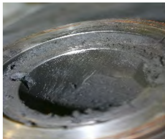
Rys. 1. Sadza na wlocie do pompy mechanicznej
