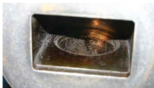
Rys. 2. Stan filtra przed systemem pompowym
