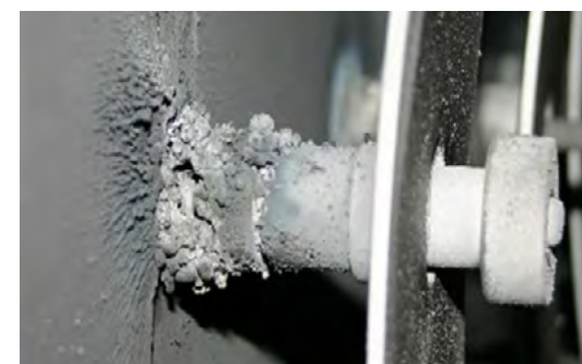
Rys. 9. Osadzanie się sadzy na ceramicznych elementach pieca
