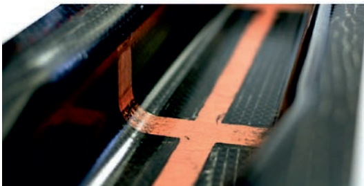
Fig. 12. Hut profile, upper with integrated SHM network. Rys. 12. Profil, górny ze zintegrowaną siecią SHM.
