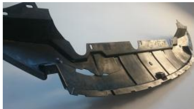
Rys. 2. Osłona zderzaka (materiał PP+EPDM+M10)
