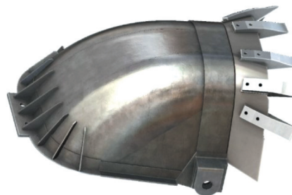
Rys. 4. Czepak z zębami tnącymi koparki wielonaczyniowej [8]
