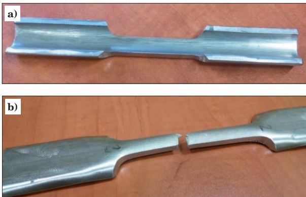
Rys. 2. Zdjęcie próbki wytrzymałościowej: (a) w stanie wyjściowym; (b) po próbie rozciągania
