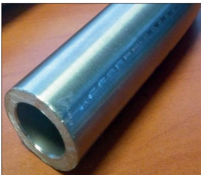
Rys. 7. Ślad dociskania szczęki na powierzchni rurki Fig. 7. Traces of clamp die on the pipe surface
