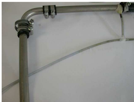
Rys. 2. Widok układu kolana przepływowomierza K5 bez otworów piezometrycznych Fig. 2. Aspect of the elbow flowmeter K5 system without piezometric apertures
