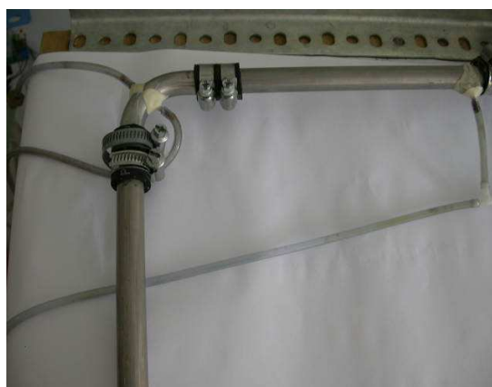
Rys. 3. Widok układu kolana przepływowomierza K5 z dwoma otworami piezometrycznymi Fig. 3. Aspect of the elbow flowmeter K5 system with two piezometric apertures
