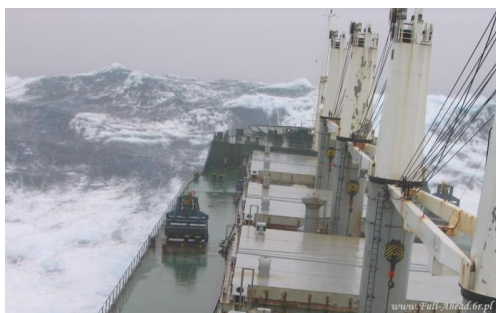
Rys. 1. Tysiące ton wody działające na konstrukcję statku podczas żeglugi w sztormie [14].
