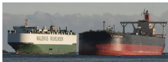
Rys.7. Widok samochodowca załadowanego i zbiornikowca olejowego ropowca pustego, pod balastem [11]
