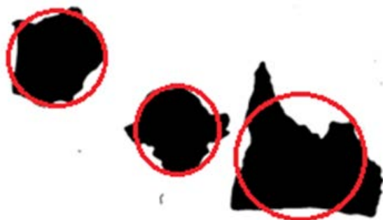
Ryc. 6. Fotografia mikroskopowa po binaryzacji w programie Image-J
