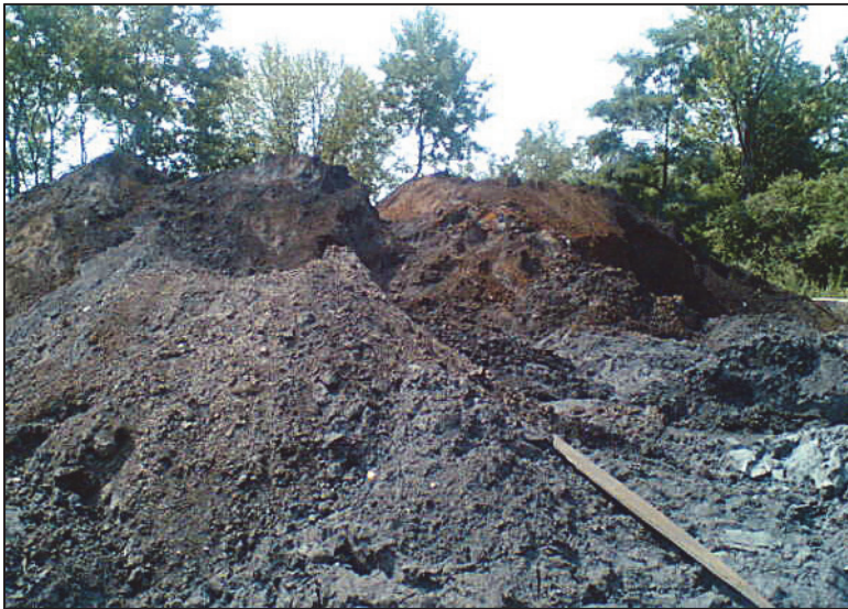
Rys. 1. Składowisko łóżyskowych odpadów poszlifierskich (fot. J.J. Hycnar) Fig. 1. Landfill of bearing grinding waste (phot. J.J. Hycnar)
