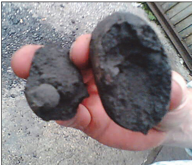
Rys. 3. Brykiet rozbity w próbie zrzutu grawitacyjnego (fot. J.J. Hycnar) Fig. 3. Briquette broken in gravitational dump test (phot. J.J. Hycnar)
