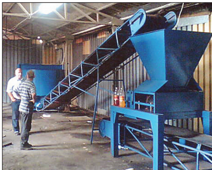
Rys. 2. Linia produkcyjna brykietów z odpadów żelazonośnych (fot. J.J. Hycnar) Fig. 2. The production line of briquettes from iron-bearing waste (phot. J.J. Hycnar)
