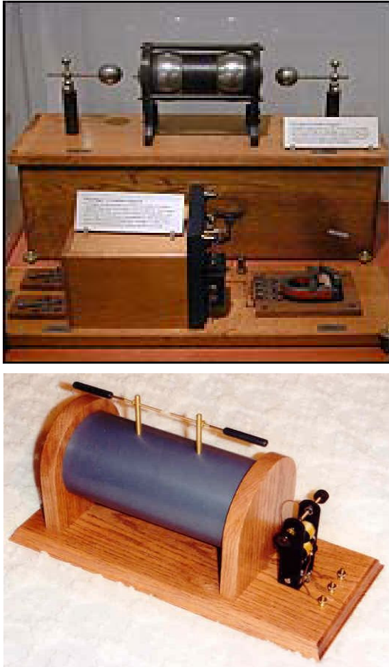
Rys. 6. Radiostacja iskrowa pracująca na fali tłumionej promieniowanej w wyniku przeskoku iskry pomiędzy elektrodami, na dole pierwszy nadajnik Marconiego [7-8]
