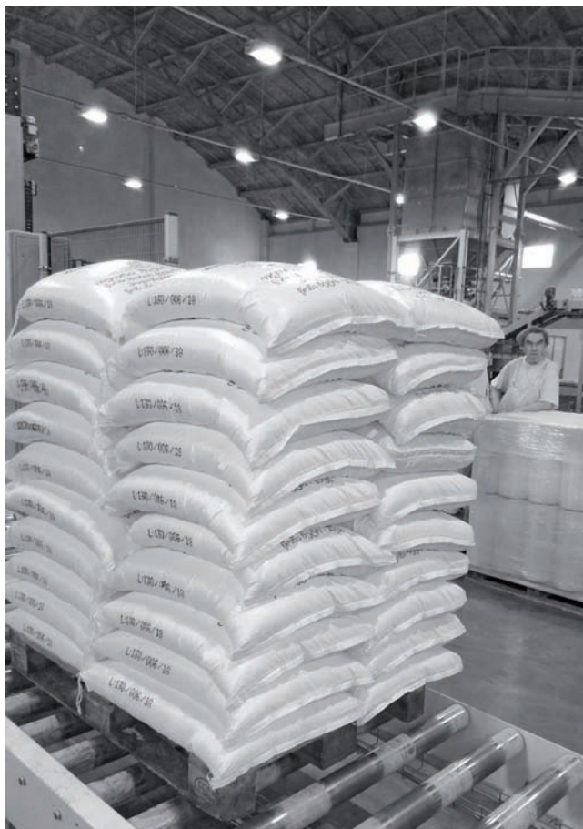
Rys. 16. Paleta z workami 25 kg ułożonymi w 10 warstwach Fig. 16. A pallet with stacked 25 kg bags arranged in 10 layers
