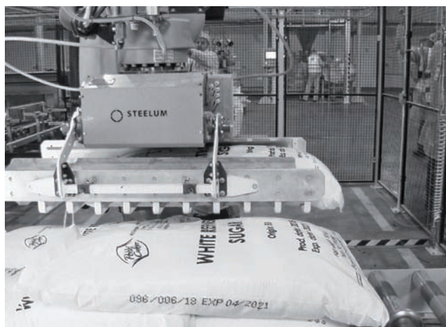
Rys. 8. Wysunięcie worka poza chwytak na skutek dynamicznego ruchu manipulatora
