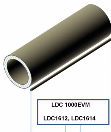
Rys. 7. Przykład zastosowania przetworników LDC w kontroli eksploatacyjnej rurociągu
