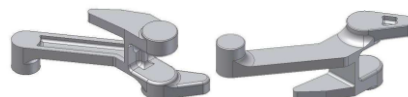
Rys. 1. Konstrukcja przedmiotu obrabianego: a) rysunek wykonawczy, b) model 3D przedmiotu, c) model półfabrykatu dźwigni (w programie Inventor)
