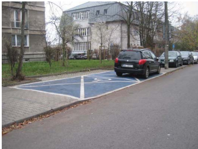
Fot. 4. „Koperty” wyznaczone w niewłaściwym miejscu, mimo to sposób parkowania pojazdów umożliwia pieszym korzystanie z części chodnika
