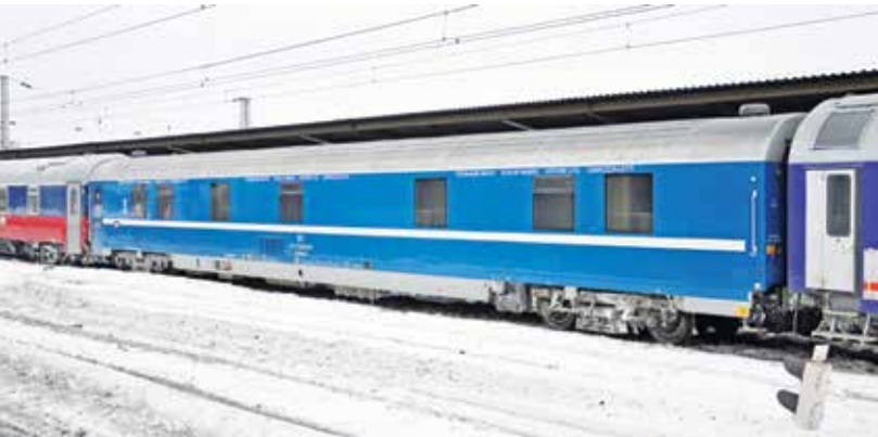
Wagon sypialny serii WLABmee (producent – FPS Poznań) kolei BC (komunikacja przestawcza 1435/1520 mm) na stacji Warszawa Wschodnia (6.02.2009 r.).
