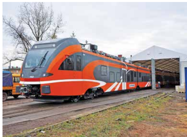
Flirt 1402 (producent – Stadler) z napędem spalinowym na EVR na torze 1520 mm na terenie zakładu Stadlera, Małaszewicze (3.11.2012 r.)
