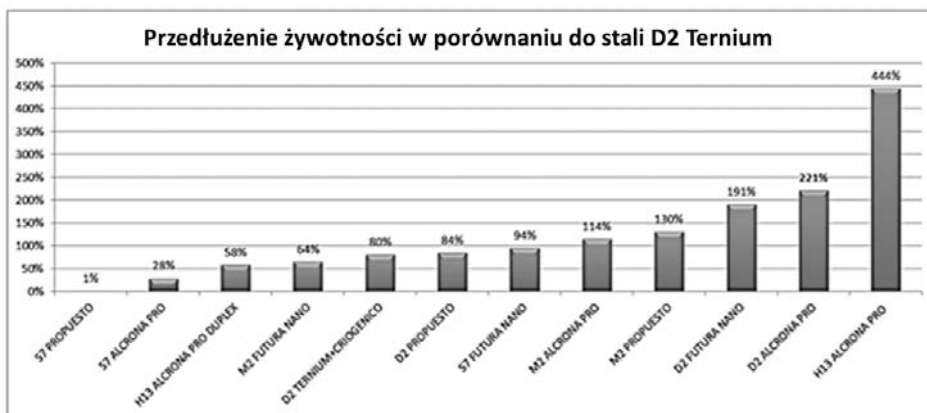
Rys. 9. Zwiększenie żywotności proponowanych materiałów w porównaniu z materiałem aktualnie stosowanym
