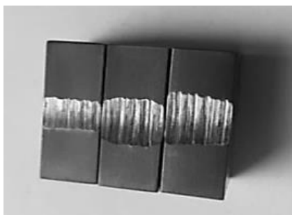
Rys. 10. Przykład wytarć próbek w badaniach tribologicznych
