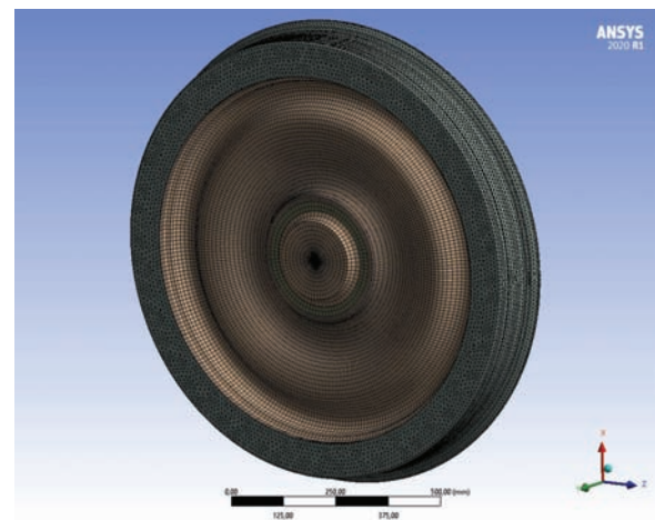
Rys. 4. Model 3D koła – siatka [opracowanie własne]
