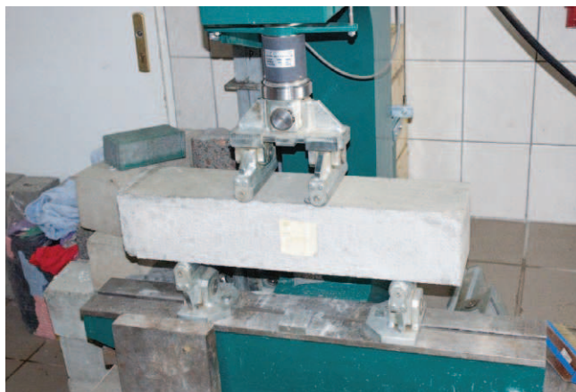
Fot. 7. Stanowisko do badania wytrzymałości betonu na rozciąganie przy zginaniu
