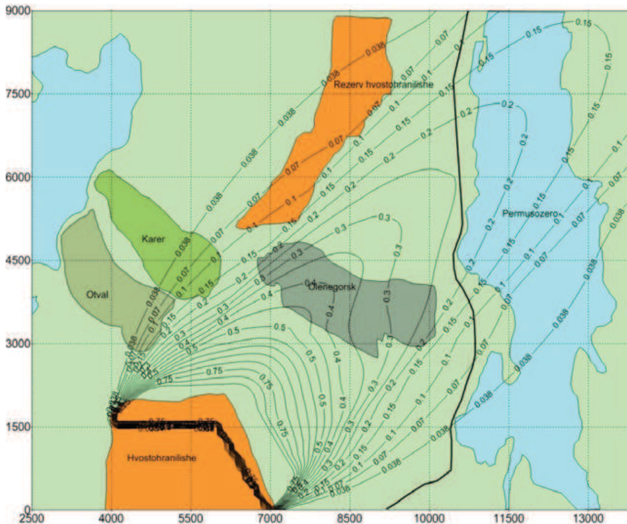
Rys. 4. Przestrzenny podział ryzyka intoksykacji dla pylenia ze zwałowiska odpadów Рис. 4. Пространственное распределение риска интоксикации пыления с хвостохранилища
