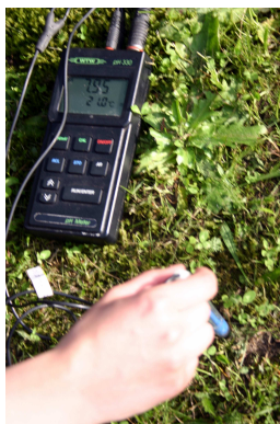
Rys. 3. Pomiar pH gleby (pH-metr WTW-330), fot. R. Kozik
