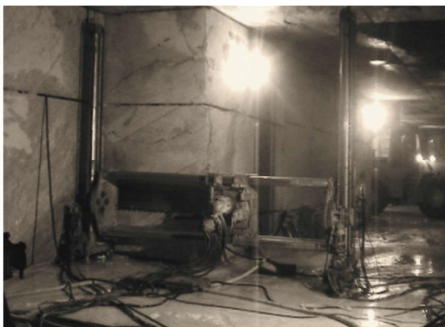
Rys. 8. Kolumnowa, łańcuchowa maszyna Fantini G.70 w wyrobisku kopalni Hotavlje I (Kortnik, Markoli 2015)
