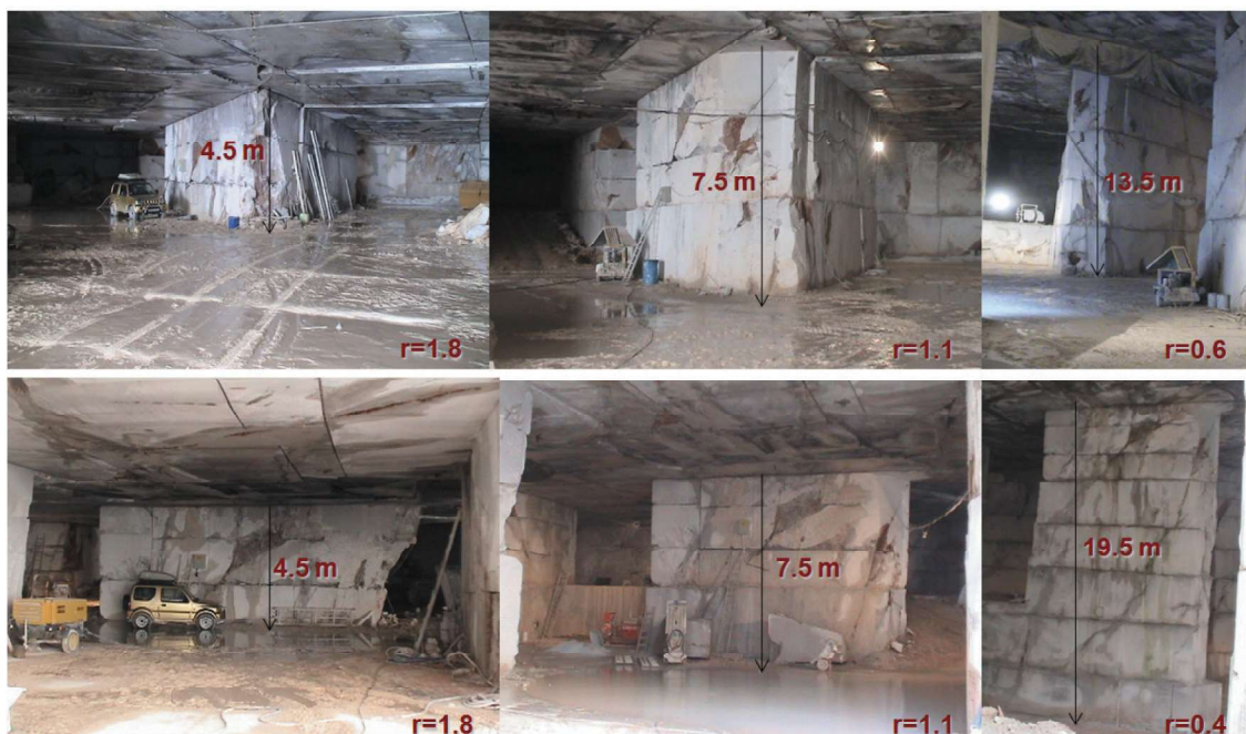
Rys. 4. Projekt i kontrola stabilności wysokich filarów ochronnych w kopalni Lipica II (Kortnik 2016), r – stosunek szerokości do wysokości
