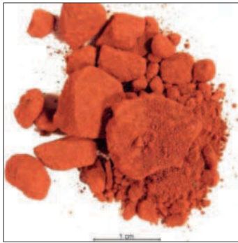
Rys. 24. Obraz makroskopowy rudy hematytowej kawałkowej z Zaporozża
