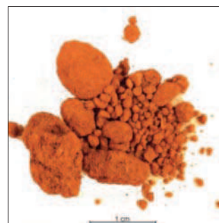
Rys. 1. Ruda hematytowa kawalkowa (Liberia) – obraz makroskopowy
