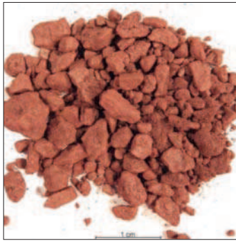
Rys. 19. Obraz makroskopowy rudy hematytowej kawalkowej z RPA
