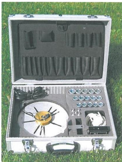
Rys. 12. Hamownia przenośna firmy Dynomet [5].
