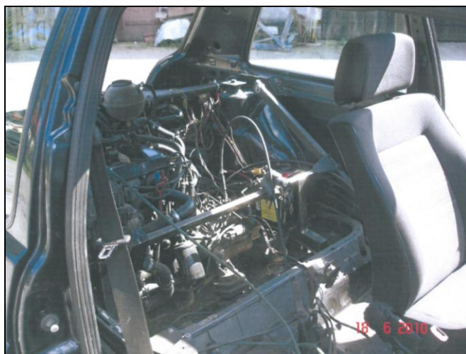
Rys. 6. Silnik wraz z zespolonym układem napędowym zamontowany w tylnej części nadwozia samochodu Duomoto [5],
