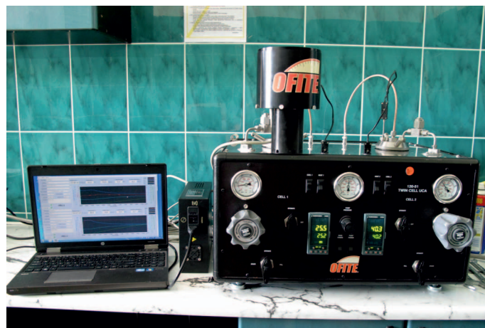
Rys. 4. Ultradźwiękowy analizator cementu (Ultrasonic Cement Analyzer) z nakładką SGSM (Static Gel Strength Measurement)
