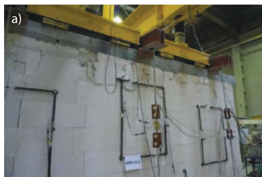
Rys. 6. Zarysowanie modeli z niewypełnionymi spoinami pionowymi: a) MNS-Z1-1, b) MNS-Z1-2
