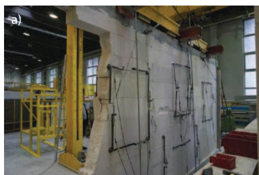
Rys. 7. Zarysowanie modeli z wypełnionymi spoinami pionowymi: a) MNS-Z2-1, b) MNS-Z2-2
