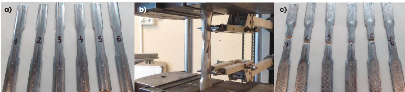
Rys. 1. Badania niszczące próbek stali z rury \varnothing 48,3 \times 3,2 mm: a) widok przed badaniami, b) w trakcie badania, c) po zniszczeniu
