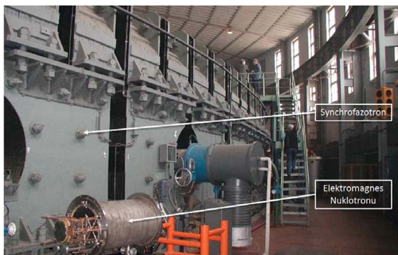
Rys. 1. Porównanie rozmiarów nadprzewodnikowego akceleratora Nuklotronu i żelaznego Synchrofazotyonu zbudowanego w ZIBJ w Dubnej w Rosji [źródło: Internet]
