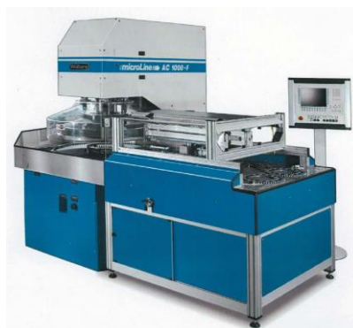
Rys. 1. Widok ogólny docierarki AC1000-F firmy Peter Wolters do szlifowania dwustronnego z kinematyką docierania, mogącej realizować różne strategie obróbkowe [5]
