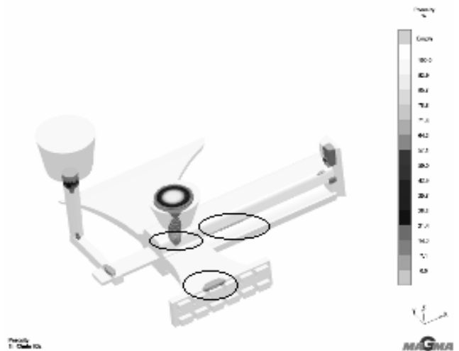
Rys. 7. Rozmieszczenie porowatości w odlewie uzyskana w wyniku symulacji wskazano obszarami
