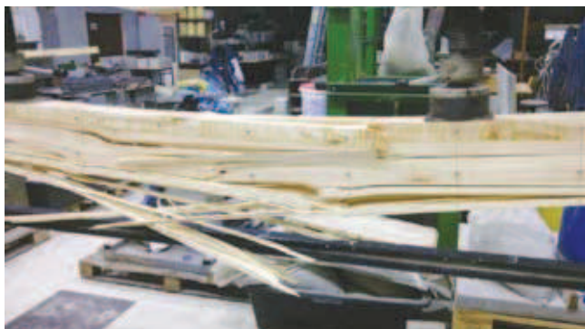
Rys. 7. Postać zniszczenia belki modelu 1
