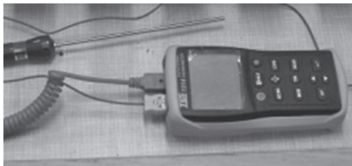
Rys. 3. Widok termometru elektronicznego zastosowanego do pomiaru temperatury Źródło: opracowanie własne
