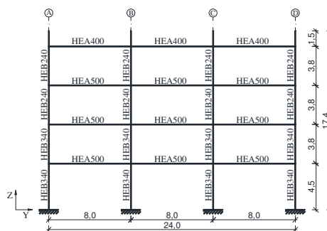
Rys. 4. Rama w osi 2 wraz z oznaczeniem przekrojów prętów i podstawowymi wymiarami
