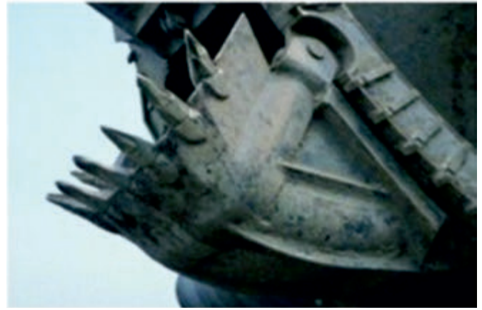
Fig. 7. Bucket of BWE KWK 1200 with increased number of teeth [10] Rys. 7. Czerpak koparki wielonaczyniowej kołowej KWK 1200 ze zwiększoną liczbą zębów [10]
