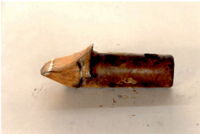
Fig. 6. Wedge-shaped pad welded self-sharpening tooth worn out Rys. 6. Ząb o kształcie klina prostego napawanych samoostrzący się po zużyciu
