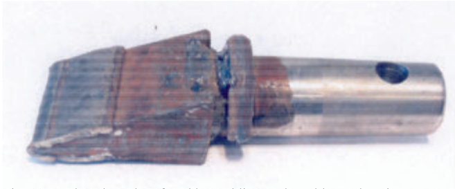
Fig. 11. Wedge-shaped surfaced by welding replaceable tooth, prior to wear Rys. 11. Ząb o kształcie klina wymienny napawany przed zużyciem
