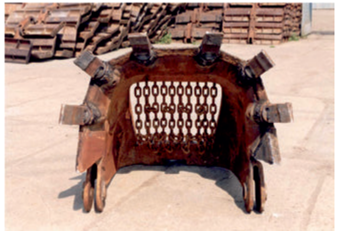
Fig. 8. View of the bucket of BWE KWK 1500 with replaceable teeth fastened in the pocket with bolts (pocket welded into the knife) Rys. 8. Widok czerpaka koparki wielonaczyniowej kołowej KWK 1500 z zębami wymiennymi mocowanymi w oprawach za pomocą sworzni (oprawy wstawane do noża)
