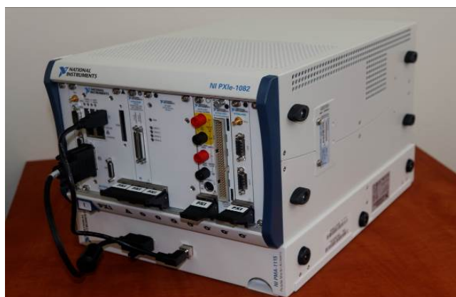
Rys. 4. Modułowy system pomiarowy oparty na platformie PXI firmy National Instruments
