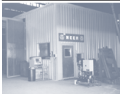
Fot. 4. Obudowa dźwiękochłonno-izolacyjna piły do cięcia rur
