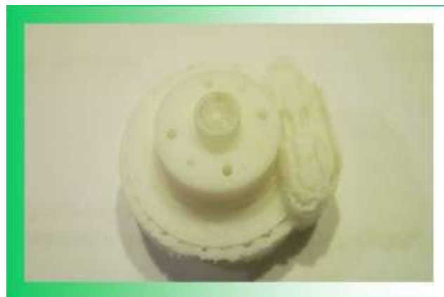
Rys. 11. Wydrukowany model tarczy hamulcowej wraz z podporami powstałymi na etapie drukowania
