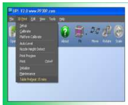
Rys.5. Inicjalizacja wydruku oraz podgrzewanie stołu roboczego
