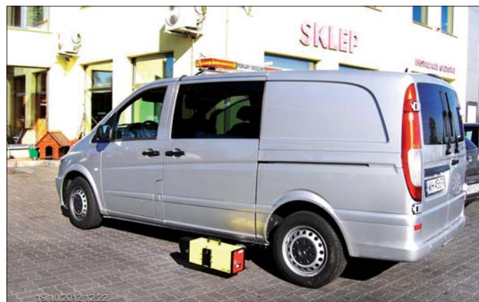
Fot. 1. Reflektometr Delta LTL-M zainstalowany na pojeździe pomiarowym
