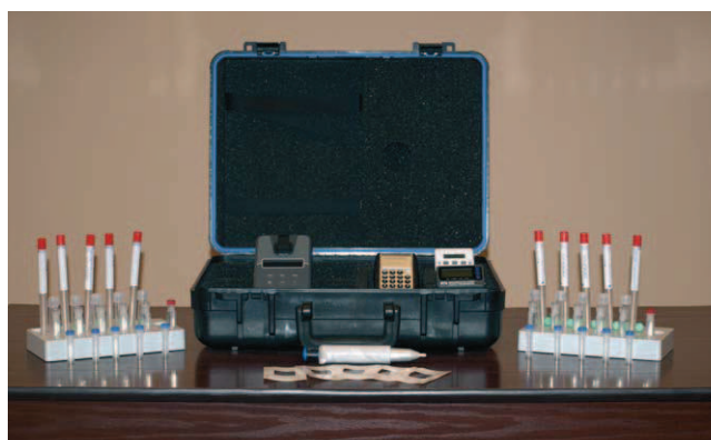
Rys. 2. Zestaw probierczy do analizy występowania oraz wzrostu zarodników grzybni. Na zdjęciu widoczne od strony lewej: kuweta z wacikami bawełnianymi w sterylnych pojemnikach (smukły pojemnik), pojemniki na substrat enzymu (biała pokrywka), standard kalibracyjny (czerwona pokrywka), pojemniki z odczynnikami (niebieska pokrywka), pojemniki do przechowywania hodowli (zielona pokrywka), instrument, kalkulator, termometr oraz sekundnik, pipeta, szablony do pobierania próbki z określonej powierzchni
