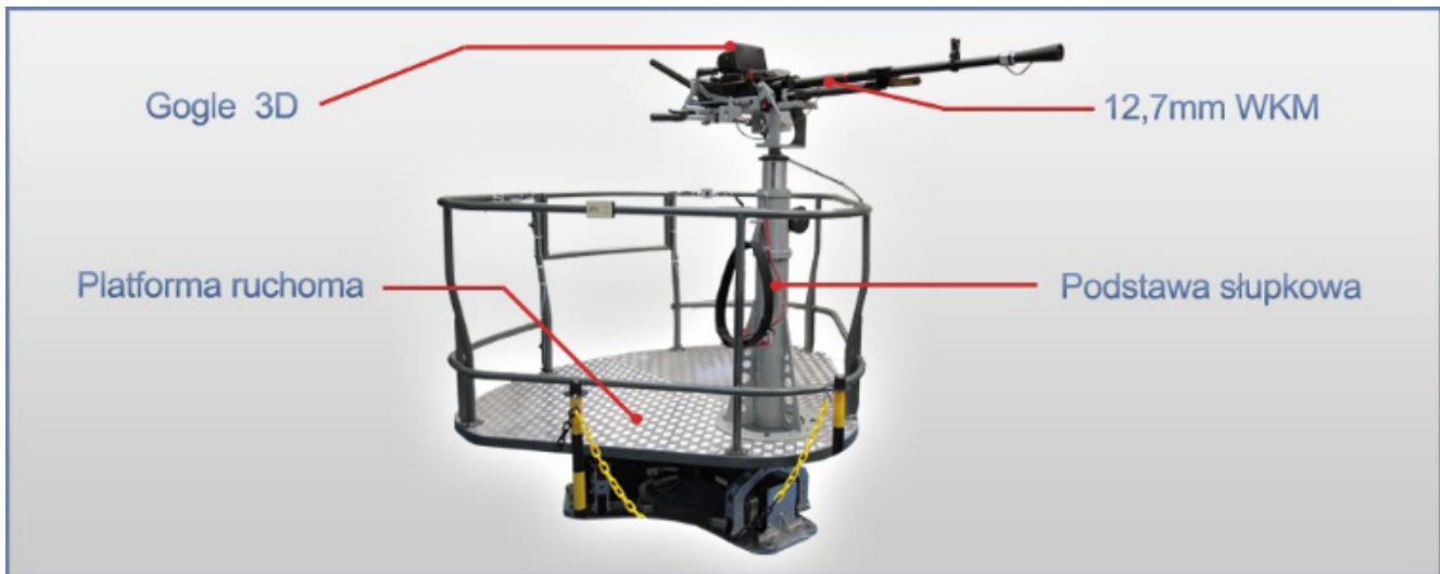
Rysunek 6 Ogólna budowa stanowiska operatora platformy treningowej 12,7 mm karabinu WKM
