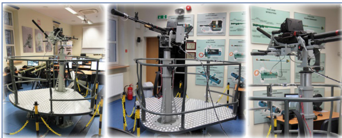
Rysunek 2 Stanowisko szkolenia operatora wraz z ukończonym ruchomą platformą treningową
