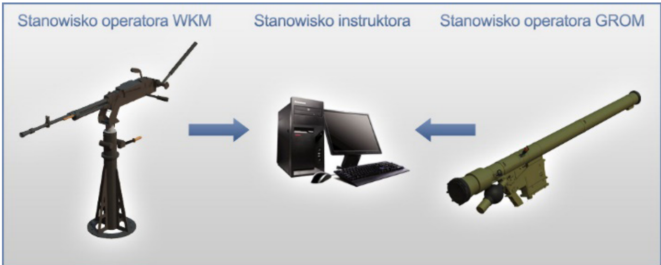
Rysunek 5 Ogólna budowa stanowiska szkolno-treningowego z 12,7 mm WKM oraz PPZR GROM
