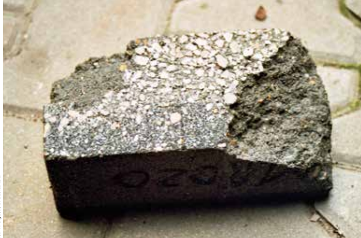
Fot. 4b. Kostka brukowa poddana badaniu na oddziaływanie soli odładzających zgodnie z PN-EN 1338:2005 – uszkodzenia betonu warstwy konstrukcyjnej
