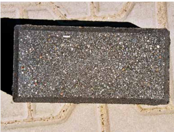
Fot. 4a. Kostka brukowa poddana badaniu na oddziaływanie soli odladzających zgodnie z PN-EN 1338:2005 – pozytywny wynik odporności betonu warstwy licowej
