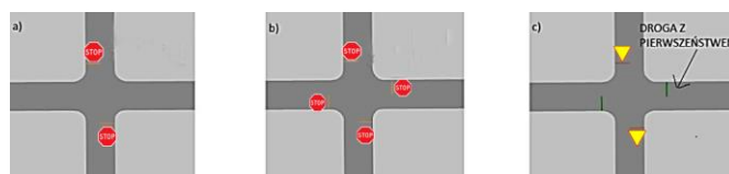
Rys. 1. Widok modelu skrzyżowań w programie VISSIM: a) znaki „stop” dla kierunków podporządkowanych b) znaki „stop” dla wszystkich kierunków ruchu c) znaki „ustąp pierwszeństwa” dla kierunków podporządkowanych
